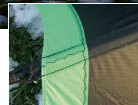
Segelmachernaht mit breiten Stoffzugaben
